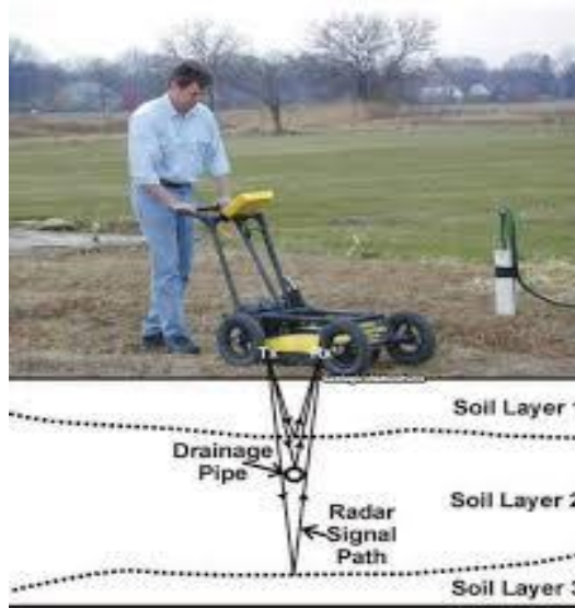
الشكل رقم (1) الأشعة المرسلة والمنعكسة في طبقات الأرض بجهاز GPR
